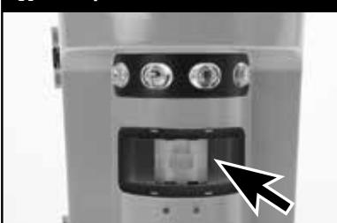
Le champ de vision du système Multi-Zone est réglable, ce qui permet d'adapter la zone de détection de mouvement en fonction de la situation. Il est possible de modifier le champ de vision en ajustant les écrans mobiles. Chaque capteur peut varier de 50 à 134 degrés.
