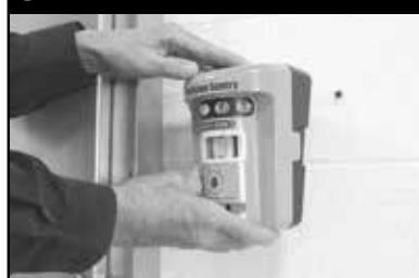
La ubicación ideal para cada unidad es a una altura entre 2-2,75 m. Las unidades Collision Sentry Multi-Zone se pueden sujetar magnéticamente o mecánicamente a paredes y otros sustratos.
