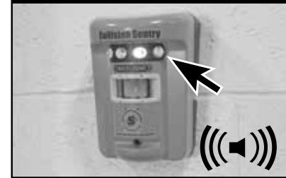
Sobald der Collision Sentry Multi-Zone sein Gegenstück erkannt hat und beide Geräte eine Bewegung erfasst haben, geben beide Geräte die Blinksequenz „Motion Detected“ („Bewegung erfasst“) aus. Die roten LEDs blinken, und es ertönt ein Audiosignal.
