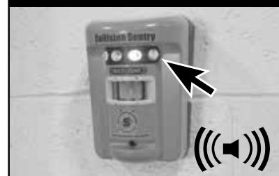
Si le système Collision Sentry Multi-Zone a repéré son partenaire et que les deux unités ont détecté un mouvement, ces derniers affichent l'alerte clignotante « Motion Detected » (« Mouvement détecté »). Les voyants LED rouges clignotent et un signal sonore retentit.
