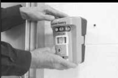
L'emplacement idéal pour chaque unité se situe à une hauteur comprise entre 2 et 2,75 mètres. Le système Collision Sentry Multi-Zone peut être fixé magnétiquement ou mécaniquement aux murs et autres supports.
