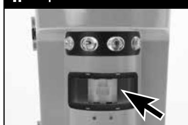
El campo de visión está optimizado para detectar el movimiento delante del sensor en un ligero ángulo descendente. Por debajo de este campo de visión no se detectará ningún movimiento. Para algunas instalaciones puede ser importante detectar el movimiento por debajo del sensor a corta distancia. El campo de visión se puede dirigir hacia abajo de las siguientes maneras:
