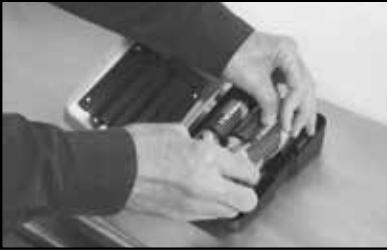
Jeder Collision Sentry Multi-Zone wird mit sechs Monozellen betrieben, die einfach ausgetauscht werden können.
