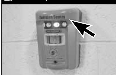
Active siempre las unidades antes de la instalación. Para activar el sistema Multi-Zone debe primero instalar las pilas. Abra la tapa del compartimiento de las pilas de una de las unidades e introduzca 6 pilas D en la dirección indicada en el compartimiento. No importa qué unidad se activa primero. Una vez instaladas las pilas, la unidad pasará por un período de calentamiento de aproximadamente 35 segundos. Active la segunda unidad de la misma manera con las 6 pilas D restantes.
