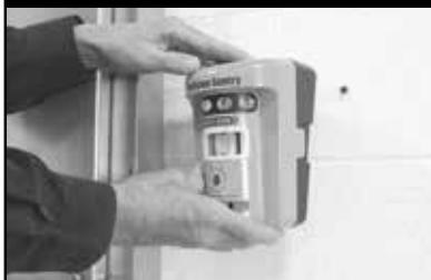
Idealerweise sollten die Geräte jeweils in einer Höhe von 2 bis 2,75 m angebracht werden. Der Collision Sentry Multi-Zone kann magnetisch oder mechanisch an Wänden und anderen Oberflächen befestigt werden.
