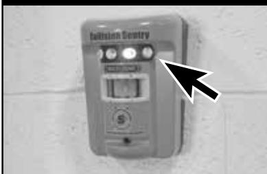
Aktivieren Sie die Geräte vor der Installation. Setzen Sie die Batterien ein, um den Multi-Zone zu aktivieren. Öffnen Sie die Batterieabdeckung eines Geräts und setzen Sie sechs Monozellen in der Richtung ein, die im Batteriefach angezeigt wird. Es ist egal, welches Gerät zuerst aktiviert wird. Sobald Sie die Batterien eingesetzt haben, durchläuft das Gerät eine etwa 35 Sekunden lange Aufwärmphase. Aktivieren Sie das zweite Gerät auf die gleiche Weise mit den restlichen sechs Monozellen.
