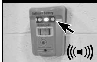
Si una unidad Collision Sentry Multi-Zone ha detectado a su pareja y ambas detectan movimiento, las dos mostrarán el patrón de parpadeo «Motion Detected» (Movimiento detectado). Los LED rojos parpadearán y se escuchará una indicación sonora.
